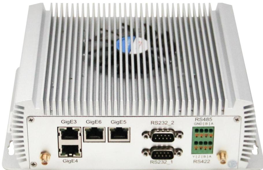
11F1E6人工智能计算平台（以下简称11F1E6）可适配搭载 NVIDIA Jetson Orin NX/ Orin Nano 核心模块。最高可提供 100 TOPS 的算力，具有丰富的对外接口，内部接口器件均采用宽温型号。
